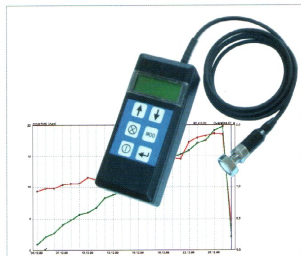
1 Adatgyűjtő kéziműszer többparaméteres trendkészítő és határérték-figyelő PC-szoftverrel
